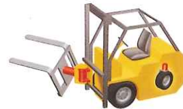
フォークリフト フォークの旋回、 特殊アタッチメントの旋回、 ステアリング
