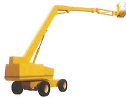
高所作業車 プラットホーム、 バスケットとジグの旋回
